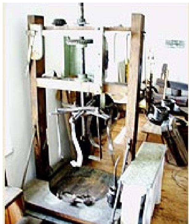
Knetmaschine zum Verkneten des gemahlene Kernbreis mit Wasser
